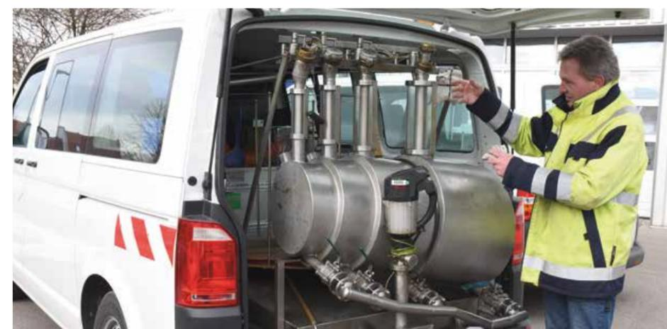
Prüfausrüstung für die Eichung von Zapfsäulen
