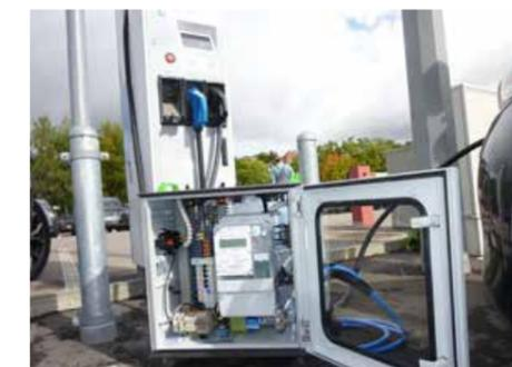
Prüfausrüstung zur Prüfung von Wechselstrom-Ladesäulen
